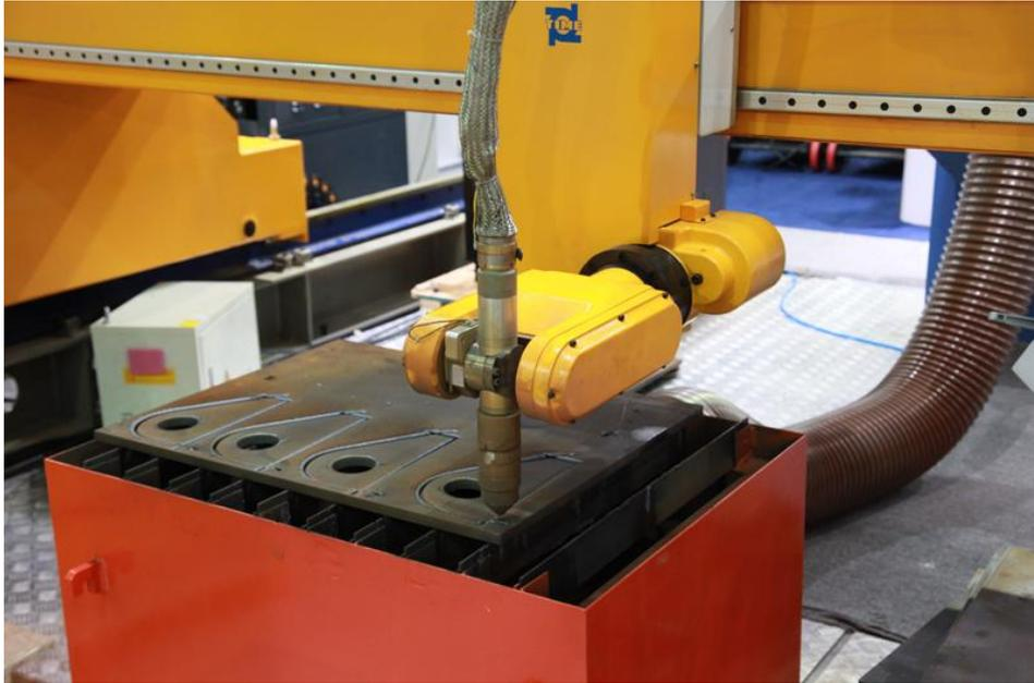
图 3：数控等离子切割机喷嘴高度
