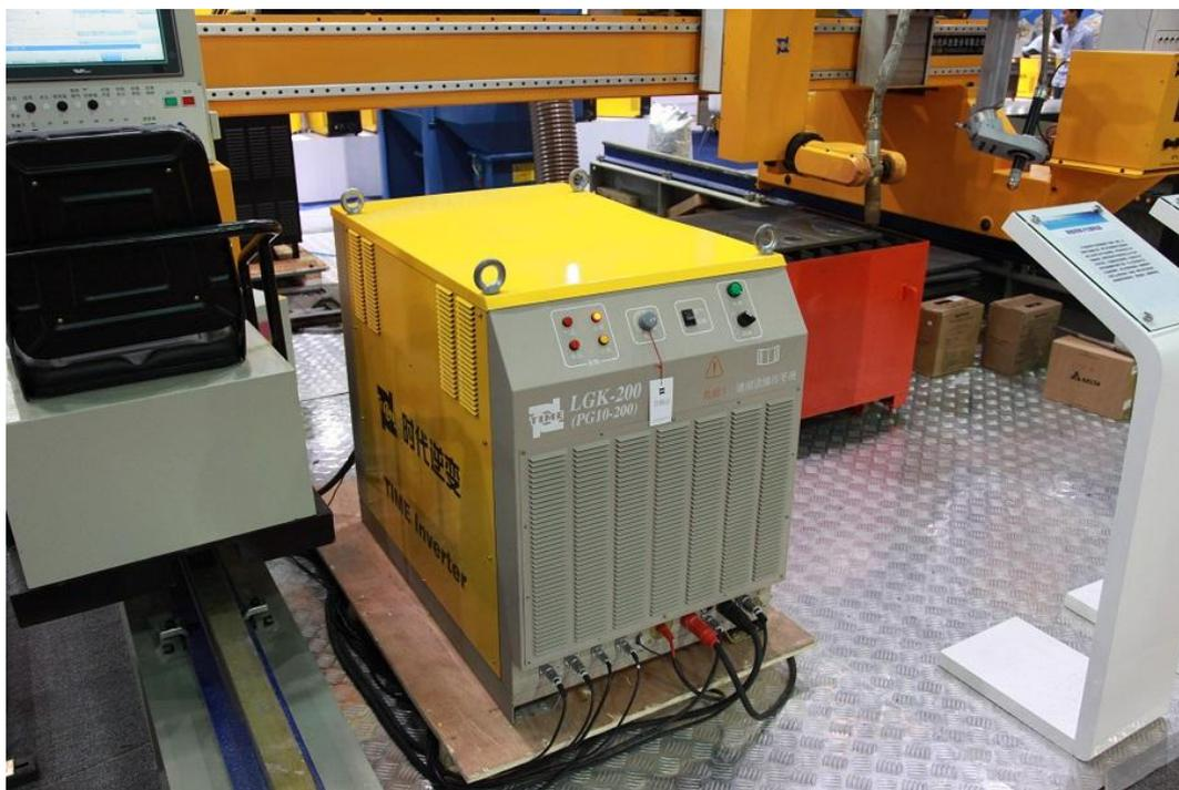
图 2：数控等离子切割机切割电源
