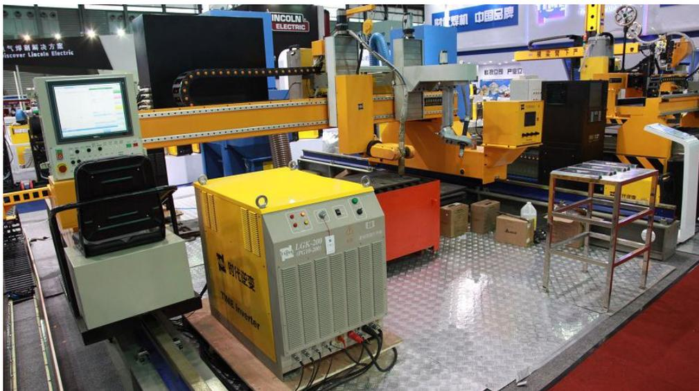
**等离子弧切割**是利用高温等离子电弧的热量使工件切口处的金属部分或局部熔化(和蒸发)，并借高速等离子的动量排除熔融金属以形成切口的一种加工方法。等离子弧切割机(Plasma Cutting Machine)是借助等离子切割技术对金属材料进行加工的机械。
